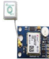
Figure 5. Ublox NEO-6M GPS Module [15].
